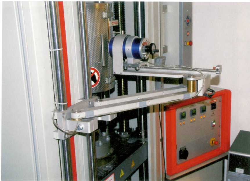
Bild 8: Ansicht der Zugprüfmaschine zur Messung des Kriechverhaltens (Zwick & Roell) mit Ofen und Dehnungsaufnehmer.
